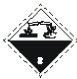
classe 8 substância corrosiva
